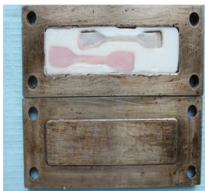
Рис. 3 – Стальная пресс-форма с фторопластовым разделением и образцом для испытания
