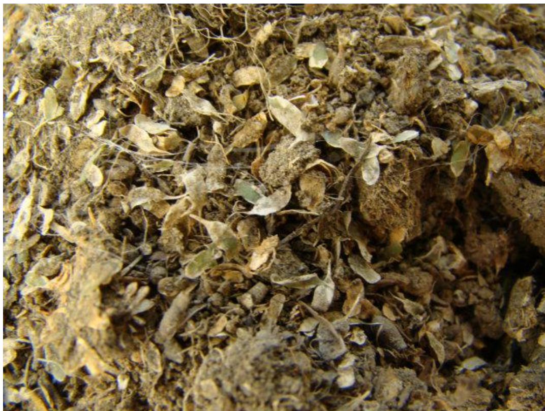
Рис. 2 – Вид донных отложений после завершения процесса низкотемпературного обезвоживания
