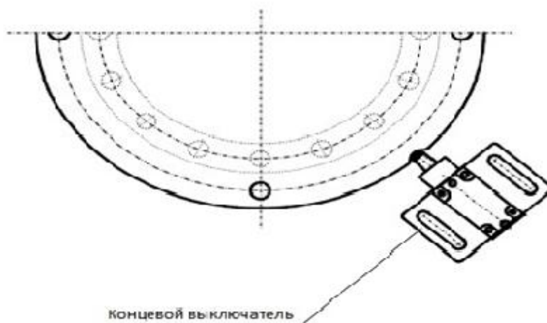
Рис. 2 – Устройство контроля проворачивания шкива тягового каната
