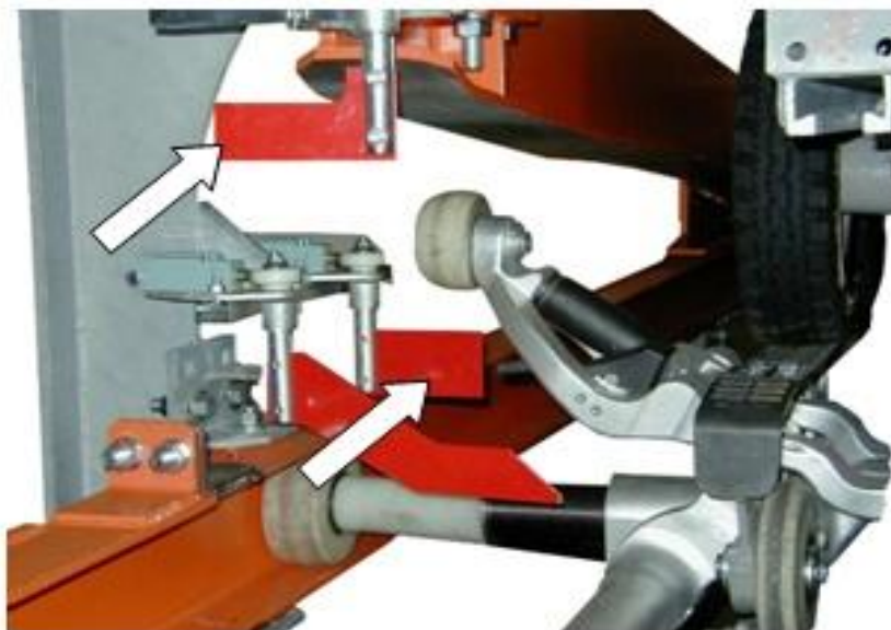
Рис. 7 – Устройство контроля зацепления зажима и диаметра каната 10%
