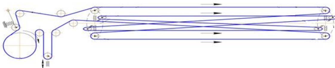
Рис. 5 – Схема ременной передачи
