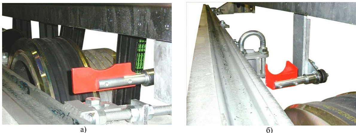
Рис. 10 – Устройства контроля оложение каната по вертикали (а) и горизонтали (б)
