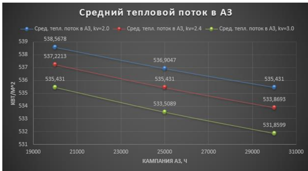
Рис. 4 – Зависимость среднего теплового потока от кампании а.з. для трех значений коэффициентов неравномерности
