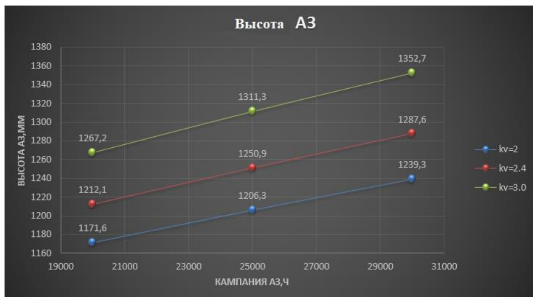
Рис. 2 – Зависимость высоты активной зоны от кампании а.з. для трех значений коэффициентов неравномерности
