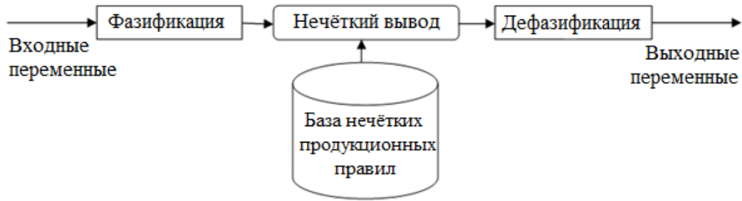
Рис. 1 - Структурная схема нечёткого логического вывода
