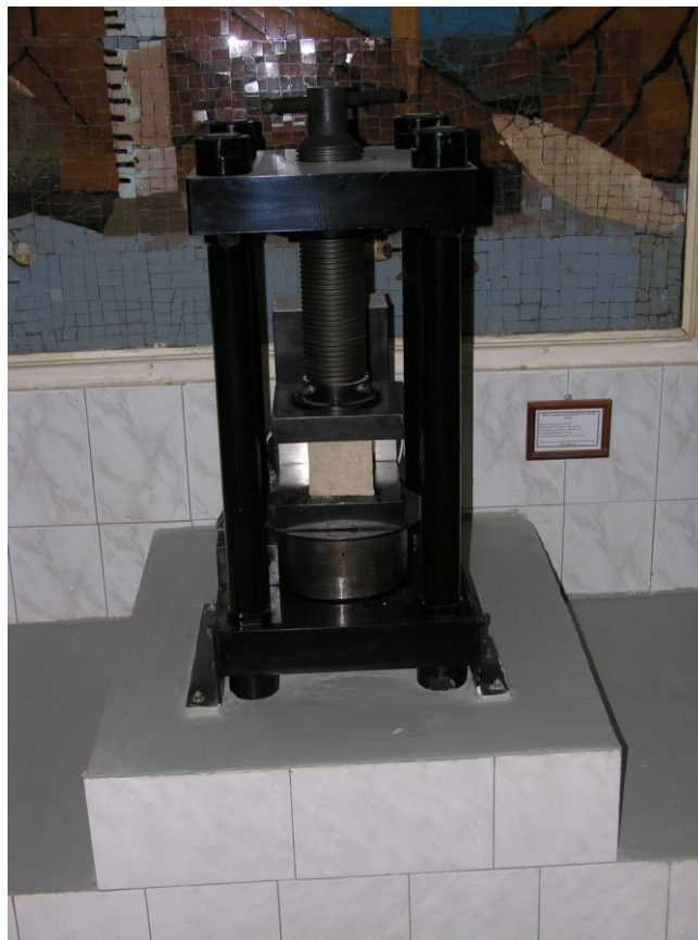
Рис. 1 – Пресс гидравлический ВМ-3.5.1 для испытания образцов на сжатие
