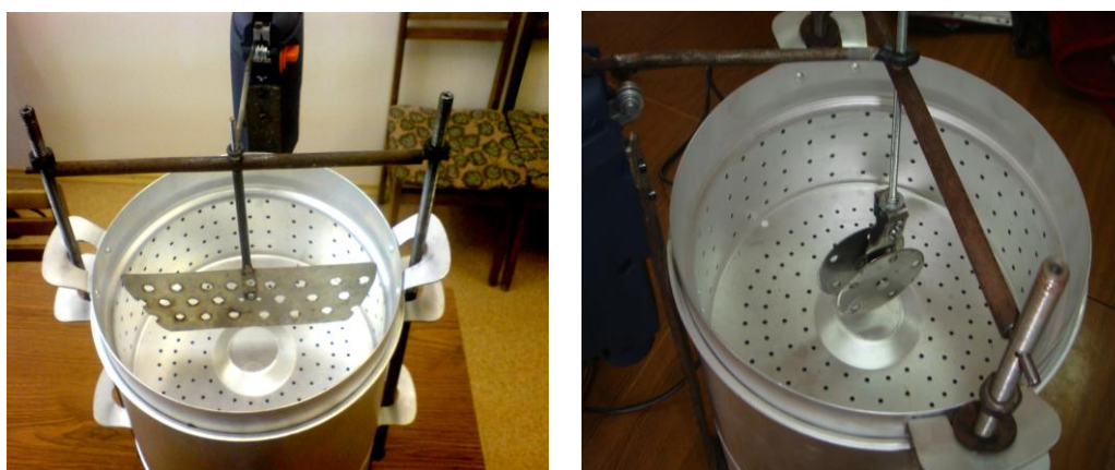
а) до изменения конструкции лопасти лопасть - в виде призмы
