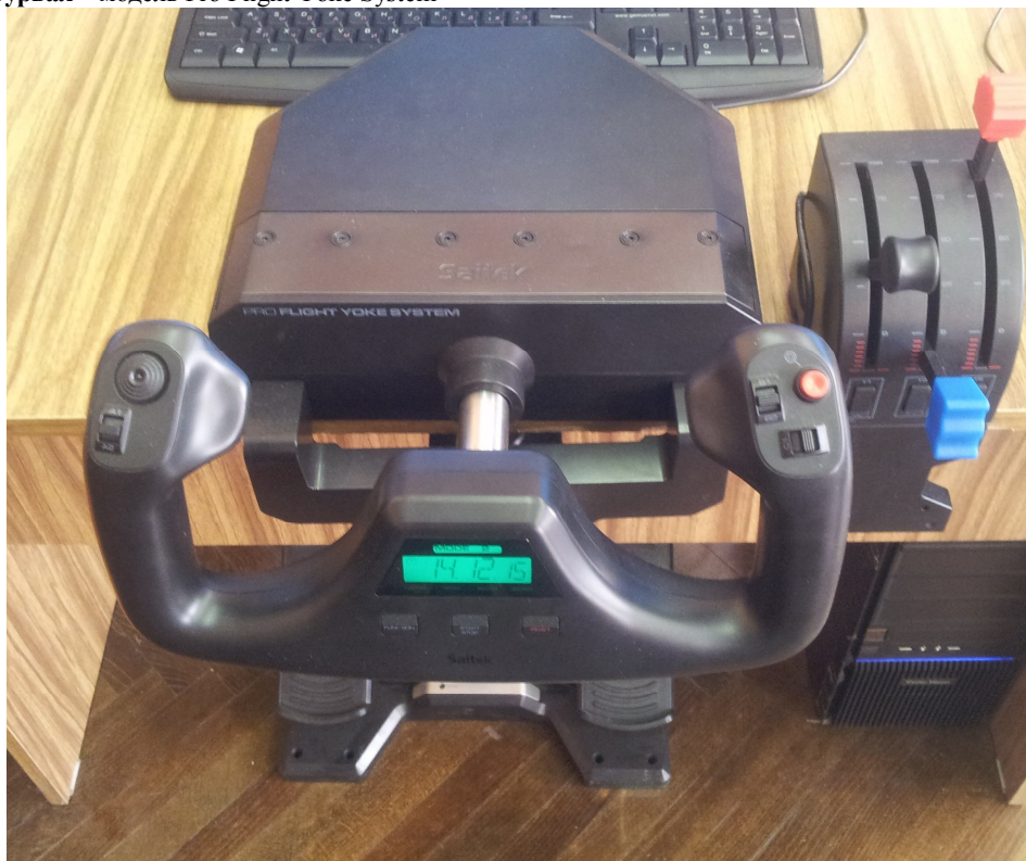
Рис. 3 Штурвал, блок управления двигателем и педали
