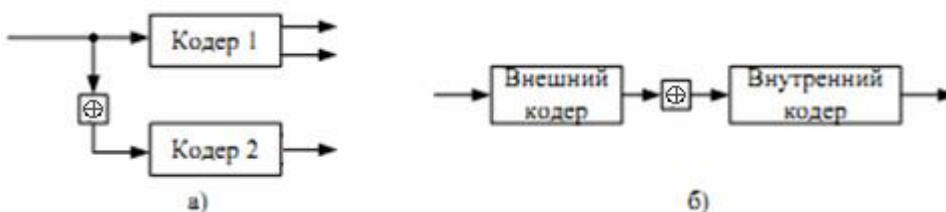
Рис. 1. Схема кодера параллельного (а) и последовательного (б) турбокода.
