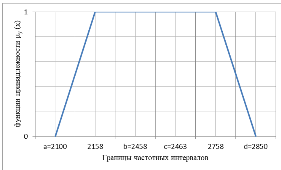
Рис. 1 – Нечеткое число энергопотребления в виде симметричной трапеции
