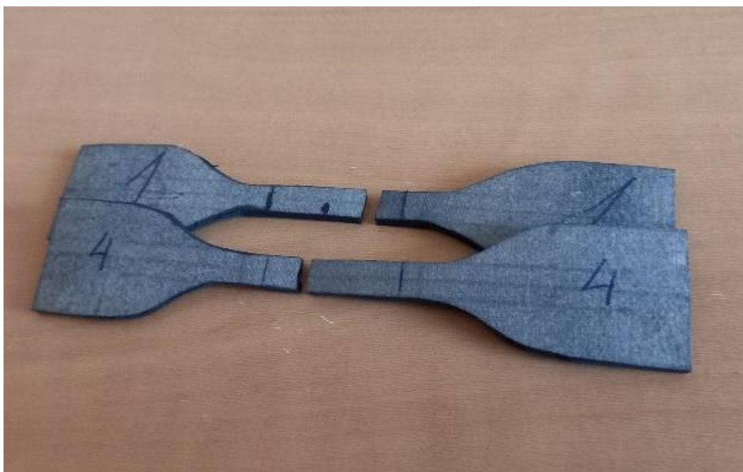
Рис. 3 – Вид разрушенных образцов
