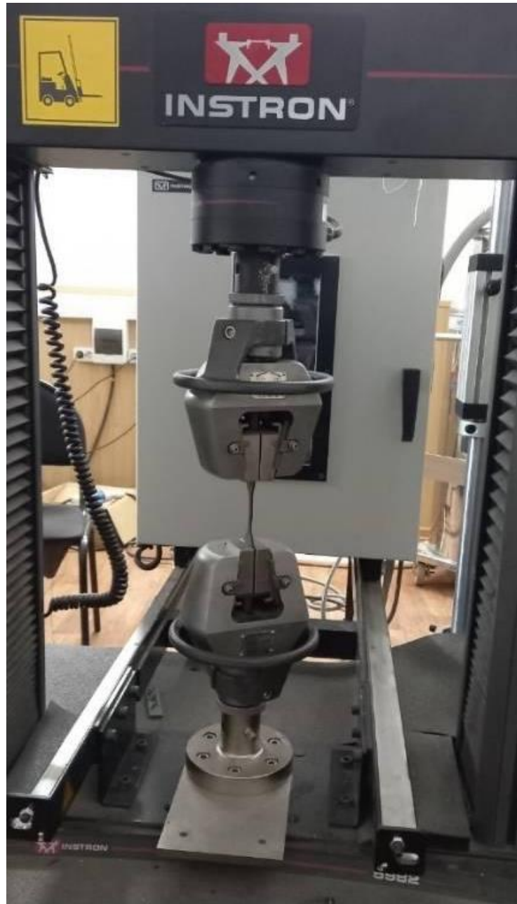
Рис. 2 – Испытательная машина INSTRON 5982 с закрепленным образцом
