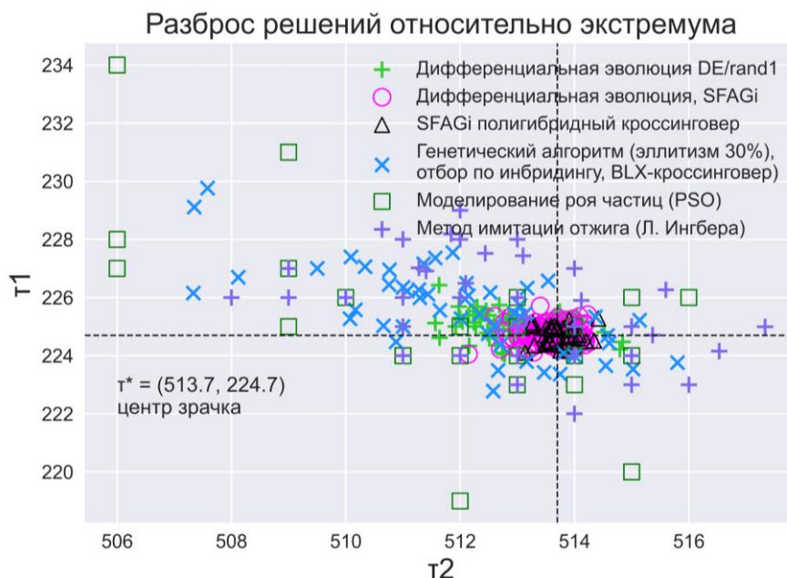
Рис. 4в – Сравнительный анализ метаэвристических методов в задаче (1): разброс решений относительно экстремума
