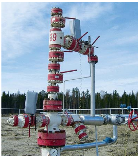
Рис. 4 – Беспроводные датчики, установленные на устье скважины
