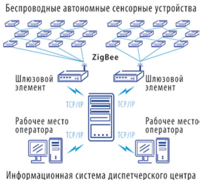
Рис. 3 – Структура беспроводной сети на основе стандарта Wireless HART
