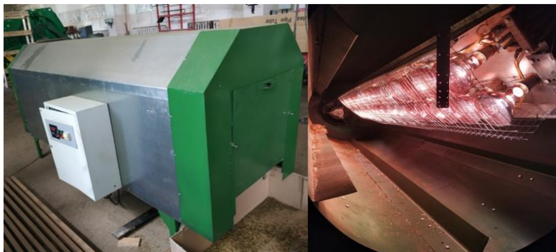
Рис. 2 – Экспериментальный образец барабанной сушилки с инфракрасным источником тепла
