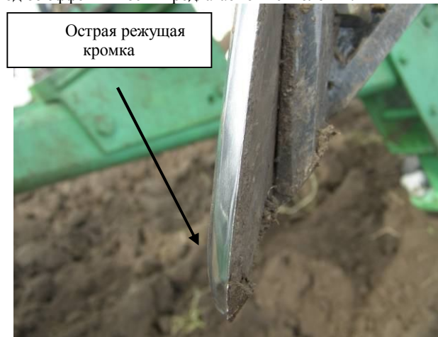
Рис. 5 - Внешний вид лемеха плуга с защитным покрытием после 120 Га наработки. Износ 3,1 мм, отсутствие затупления режущей кромки
