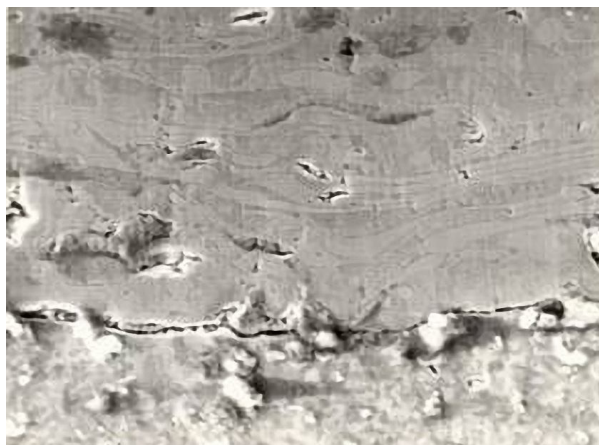
Рис. 3 - Хромовое покрытие, нанесенное газопламенным способом на стальной образец. Увеличение x400
