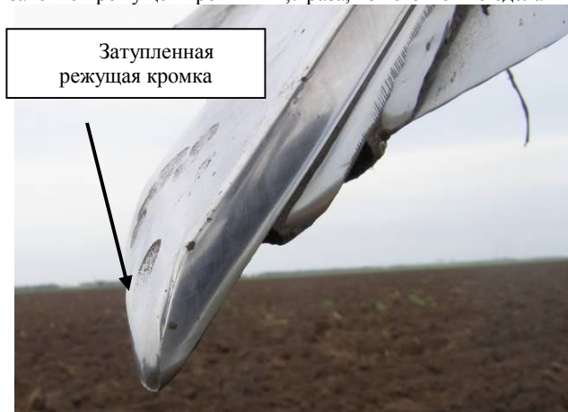
Рис. 4 - Внешний вид лемеха плуга без защитного покрытия после 120 Га наработки. Износ 8,4 мм, затупление режущей кромки
