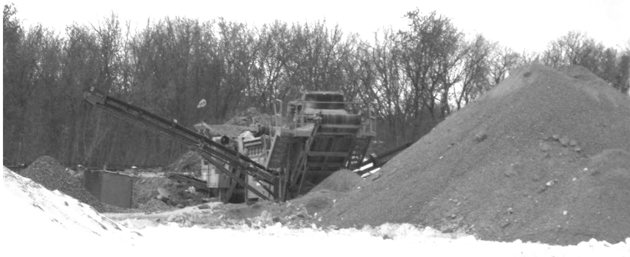
Рис. 1 –Предварительная подготовка отходов бетона
