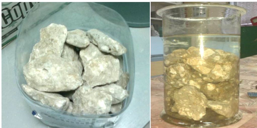
Рис.2 - Этапы проведения опыта: слева – исходный материал, справа – замоченная навеска
