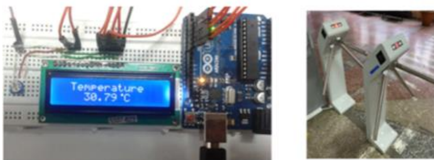
Рис. 2 – Соединение турникета и модуля бесконтактного термометра
