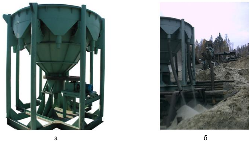
Рис. 3 – Пневмосепаратор ПОС-2000 (а) общий вид и (б) пневмосепаратор в работе
