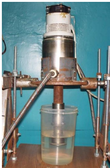
Рис. 1 – Основной узел кавитационной установки
