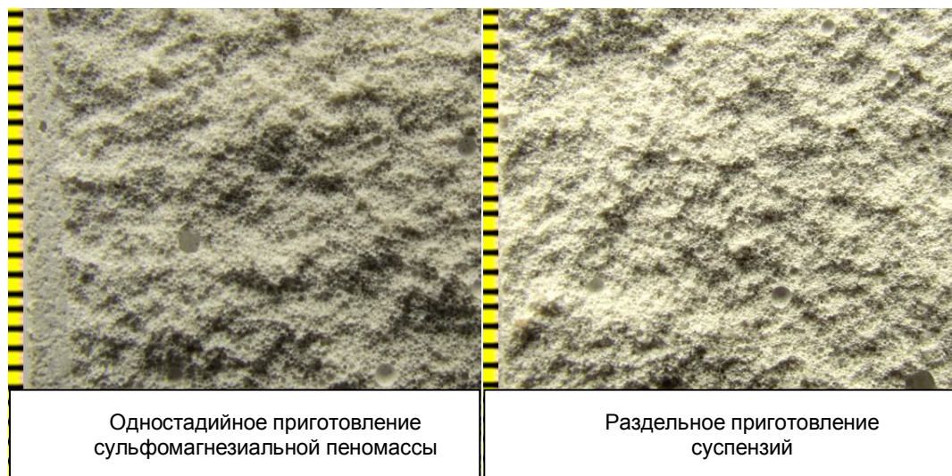
Рис. 4 – Структура сульфомагнезиального пенобетона различного приготовления
