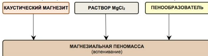
Рис. 3 – Одностадийный способ приготовления магниезиальной пеномассы
