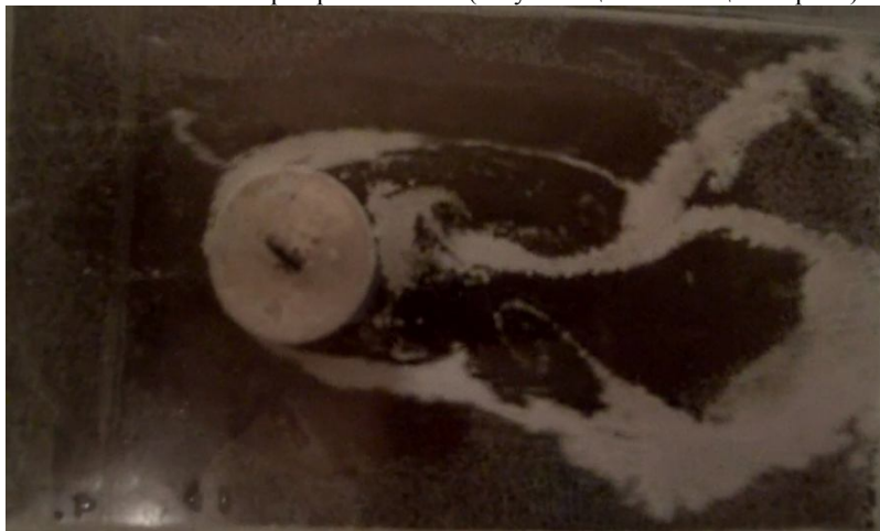
Рис.2. Обтекание цилиндра при Re=1413 (визуализация алюм. порошком).
