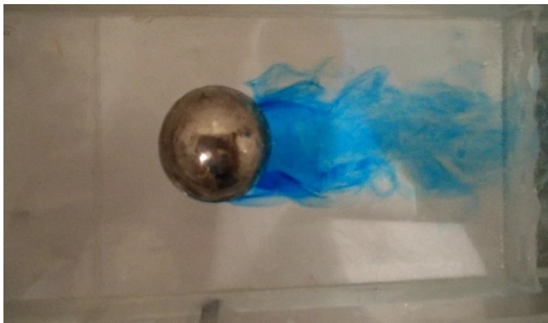
Рис. 1. Обтекание шара при Re = 1406 (визуализация с помощью чернил).
