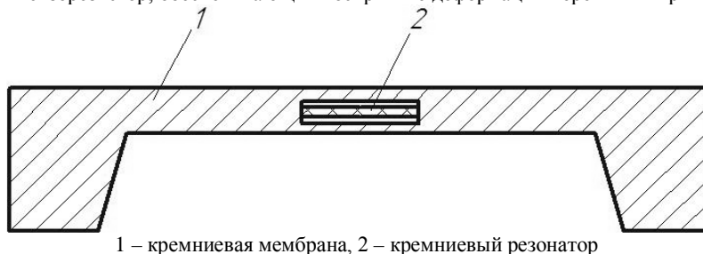
Рис. 2 – Конструкция резонансного преобразователя давления
