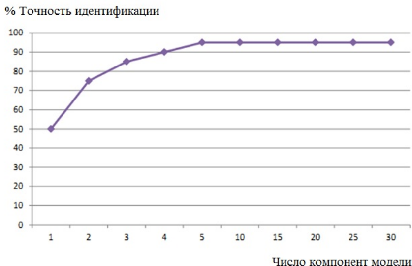
Рис. 4 – Зависимость числа правильно идентифицированных дикторов (в %) от числа компонент модели гауссовых смесей
