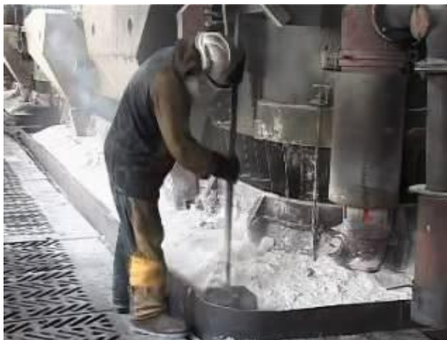
Рис. 1 – Герметизация электролизера на 160 кА
