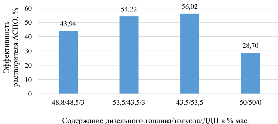
Рис. 2 – Моющая способность растворителя АСПО при различных концентрациях его компонентов (дизельного топлива, толуола и ДДП)
