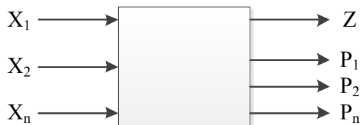
Рисунок 2 – Представление объекта исследования в виде «черного ящика» для зависимых факторов.
