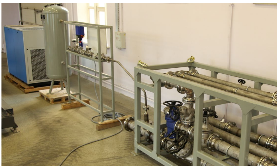
Рис. 2 - Устройство барботажа с фрагментом промываемой системы
