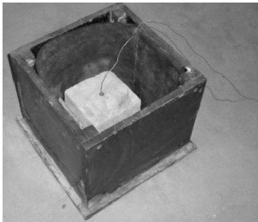
Рис. 1 – Схема расположения взрывающего блока во взрывной камере
