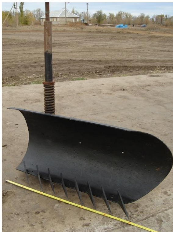
Рис. 1 – Общий вид соломонаправителя
