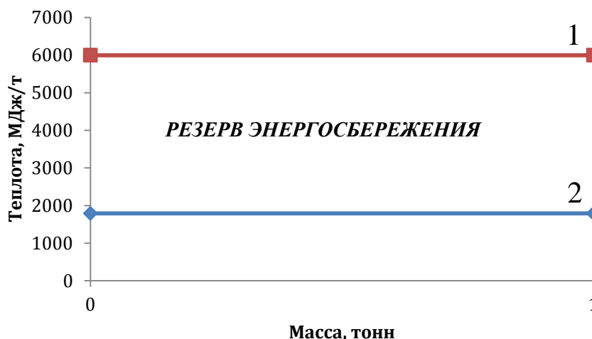
Рис. 1 – График резерва энергосбережения для производства извести, где: 1- затраты тепловой энергии в действующем производстве извести, 2 – затраты тепловой энергии на производство одной тонны извести в термодинамически идеальных условиях.
