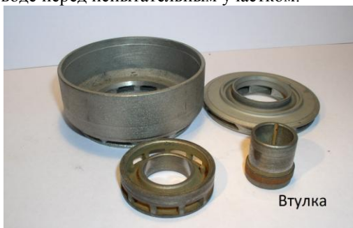
Рис. 5 – Обработанные детали с вырезанными из них образцами после испытаний
