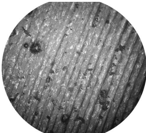
Рис. 2 – Наличие питтинговой коррозии на поверхности не обработанных изделий в процессе испытаний
