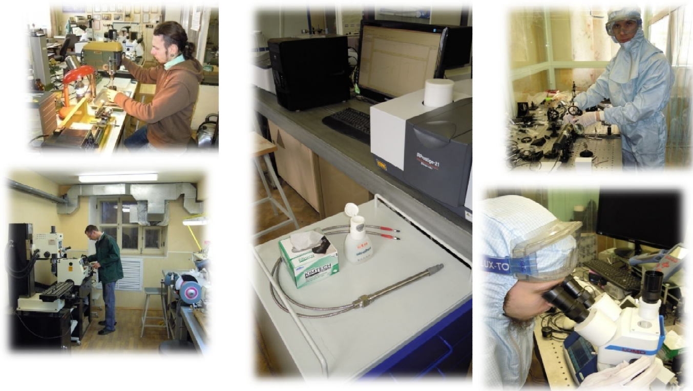
Рис. 1б. Сборка оптоволоконного зонда (1); тестирование готового продукта на оптическом стенде (2)
