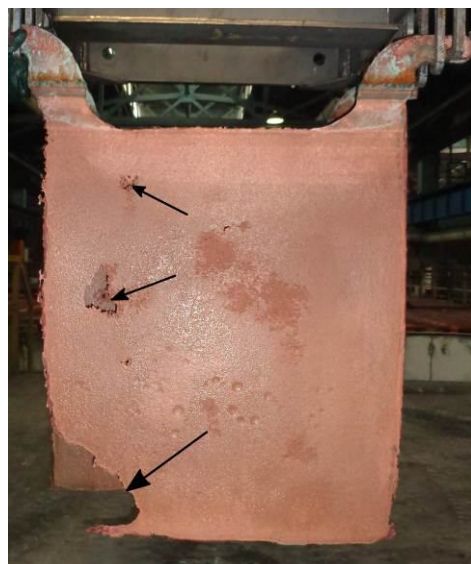
Рис. 3 – Сквозные отверстия в теле анодных остатков из-за наличия в теле анода скрытых дефектов
