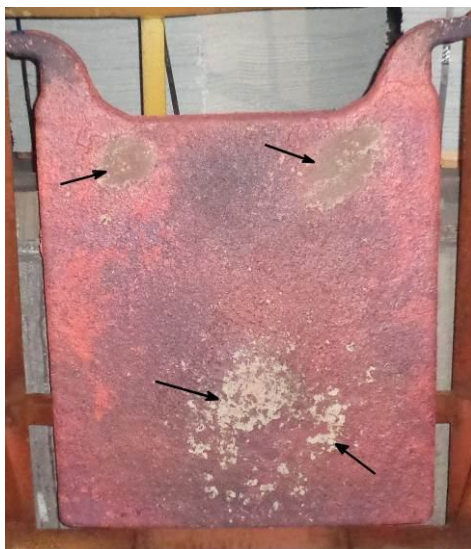
Рис. 2 – Поверхностные дефекты медных анодов
