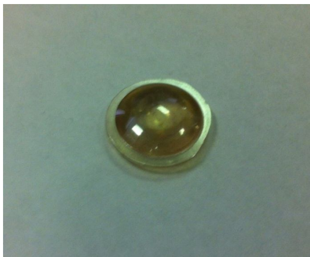
Рис. 5 – Полученное изделие, размеры линзы d = 12 мм и h = 3,6 мм
