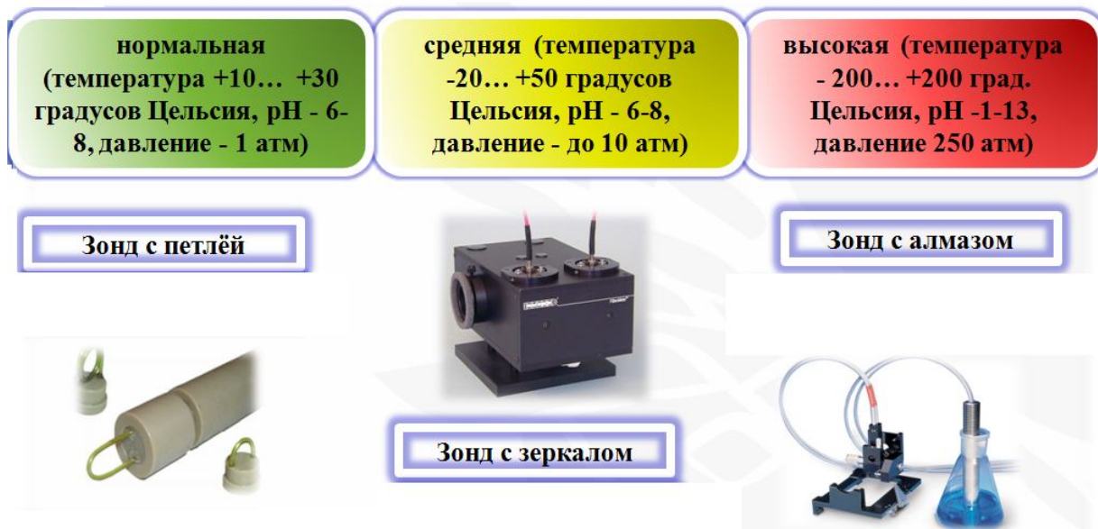
Рис.1а. Различные типы зондов, необходимые для анализа образцов в различных агрегатных состояниях и с различной степенью агрессивности
