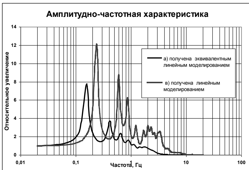
Рис. 1 – Амплитудно-частотная характеристика вертикально-неоднородной слоистой среды под площадкой проектируемого строительства жилого комплекса по пер. Аркадиевскому, 9/1 в г. Одессе получена а) эквивалентным линейным моделированием; в) линейным моделированием
