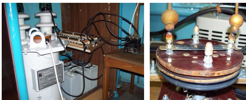
Рис. 2 – Силовая часть установки и вращающийся блок с разрядниками
