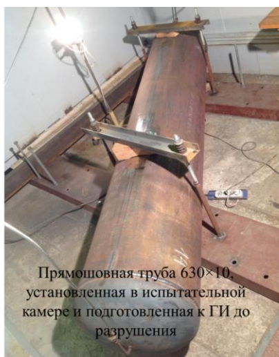
Рис. 9 – Проведение гидравлических испытаний до разрушения
