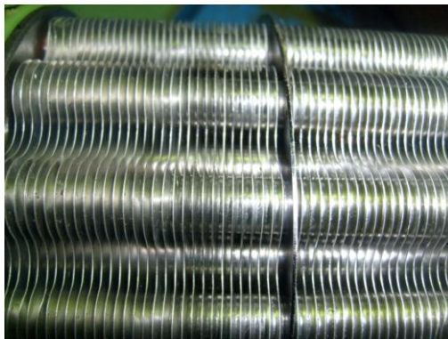
Рис. 2 – Внешний вид сердцевин теплообменника 740.90-1013200
