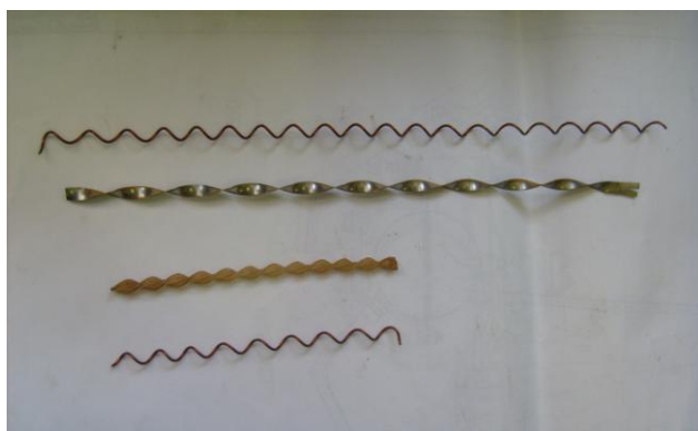
Рис. 1 – Внешний вид турбулизаторов использованных при испытаниях
