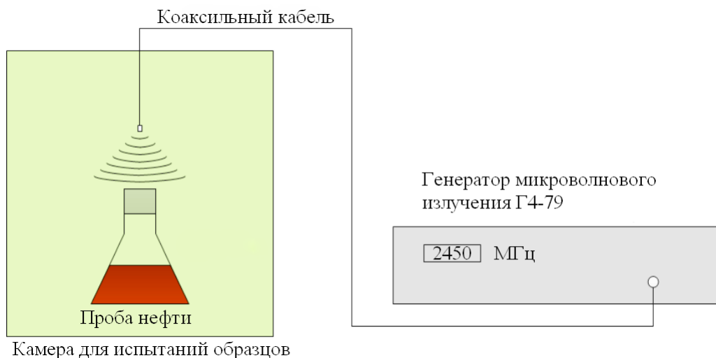
Рис. 1 – Схема экспериментальной установки
