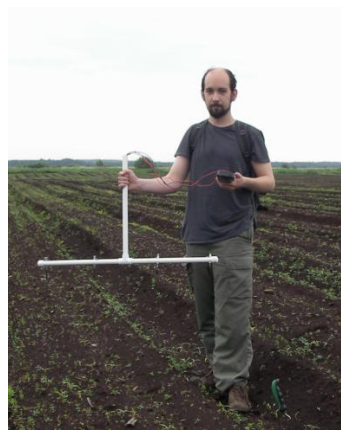
Рис. 2 – Прибор LandMapper и установка для профилирования (а), работа в поле (б) [6]
