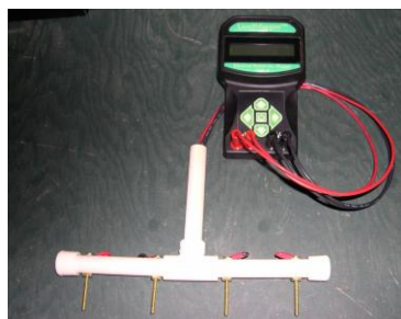
Рис. 2 – Прибор LandMapper и установка для профилирования (а), работа в поле (б) [6]
