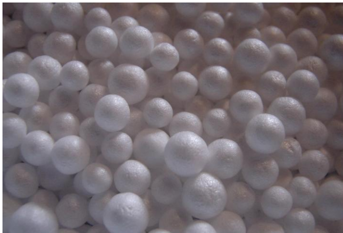
Рис. 1 – Шарики ППС, получаемые на стадии предварительного вспенивания
