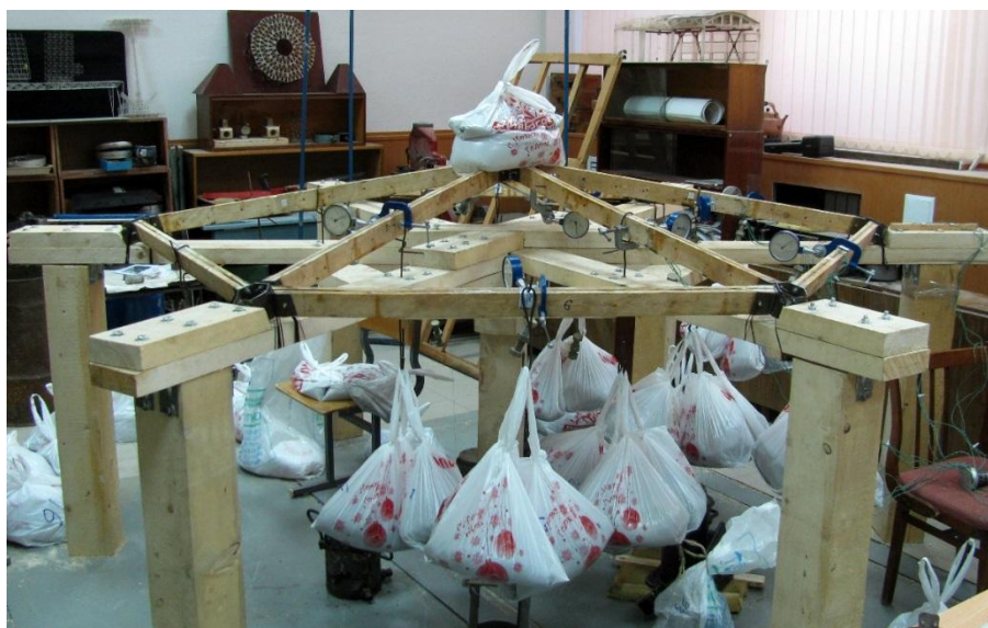
Рис. 10 – Расположение крючьев с подвешенными грузами
