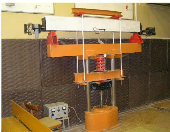
Фото 3 – Установки для исследования изгибаемых предварительно напряжённых элементов
