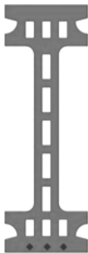
Рис. 3 – Армированная балка перекрытия из композитного материала
