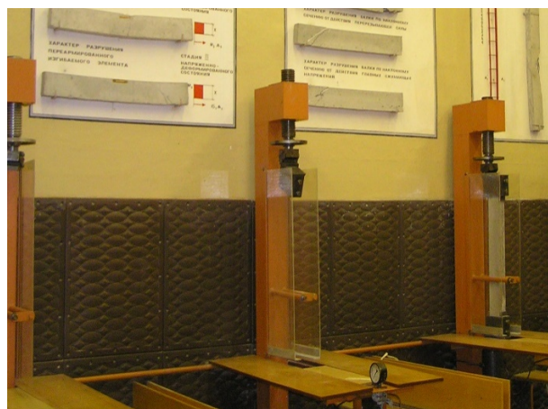
Фото 4 – Установки для исследования внецентренно сжатых элементов
