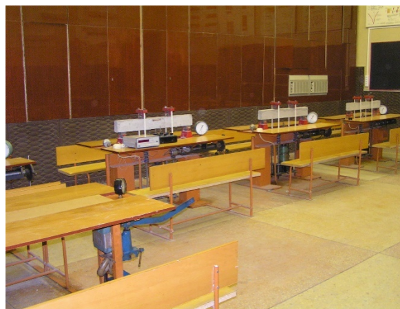
Фото 2 – Установки для исследования изгибаемых элементов
