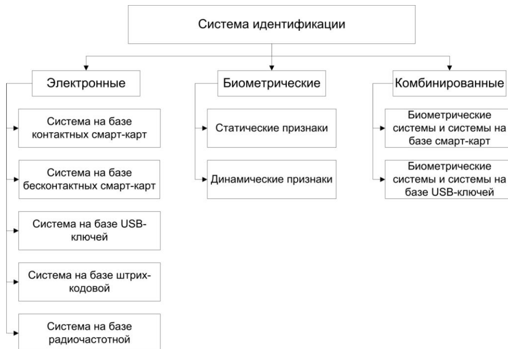
Рис. 1 – Классификация современных систем идентификации.
