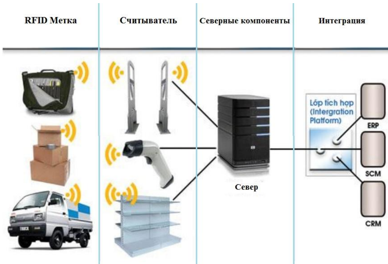
Рис .1 – Структура системы RFID
