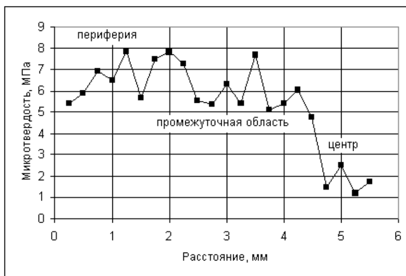
Рис. 4 – Зависимость микротвердости от расстояния в направлении от периферии к центру
