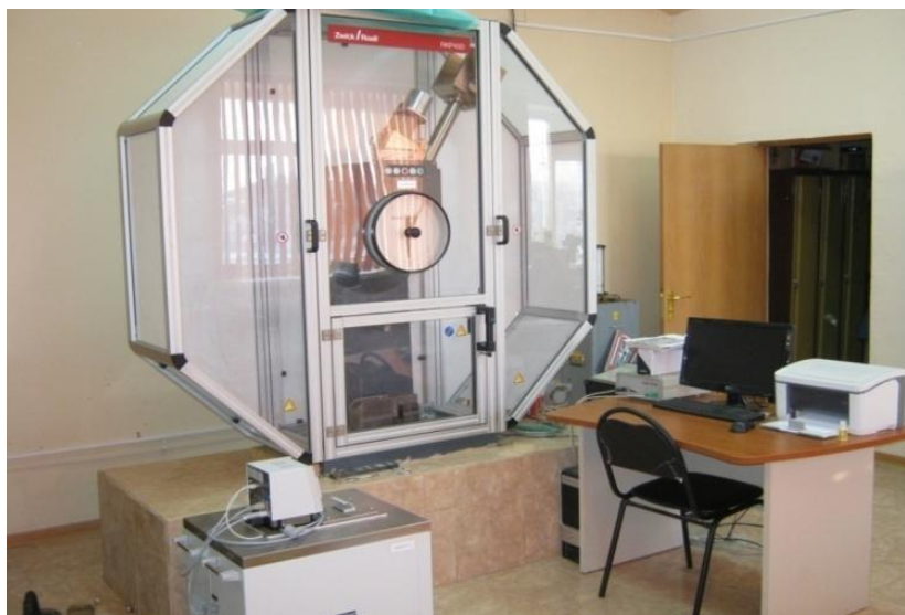
Рис. 2 – Инструментированный маятниковый копер «Amsler RKP450»
