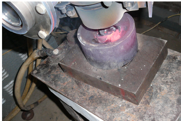
Рис. 4 – Нейтральный твердый остаток в виде остеклованного шлака
