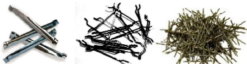
Рис. 2 - Виды стальной фибры: а – плоская фрезерованная; б – анкерная; в – волновая
