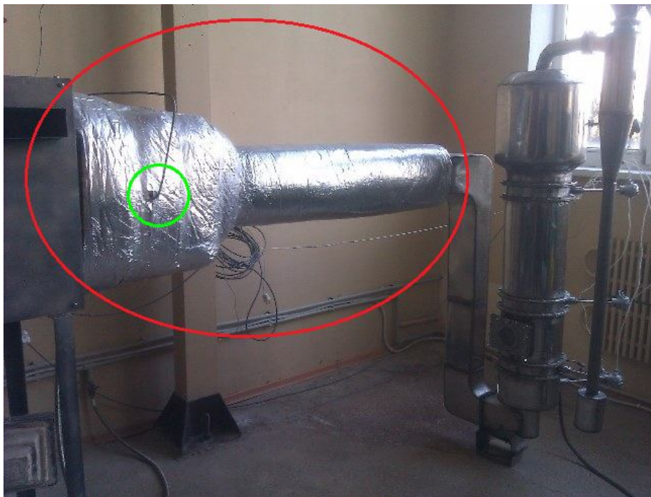
Рис. 5 – Система оросительного охлаждения генераторного газа
