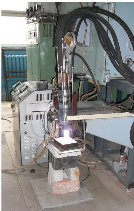
Рис. 3 – Установка для обработки плазменной утилизации ПКМ
