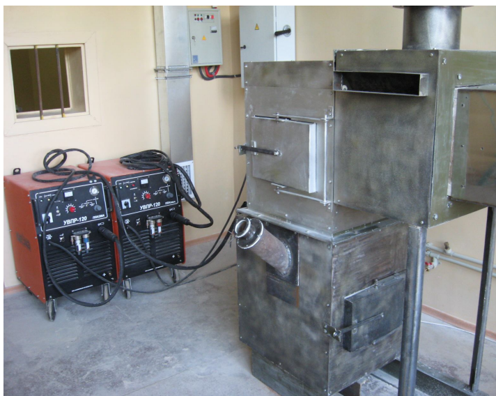
Рис. 1 – Печь для утилизации полимерных композиционных материалов
