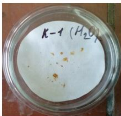
Рис. 3. Коррозионная агрессивность СОЖ Инкам-1 при КОЕ= 7 \times 10^7 кл/мл.
