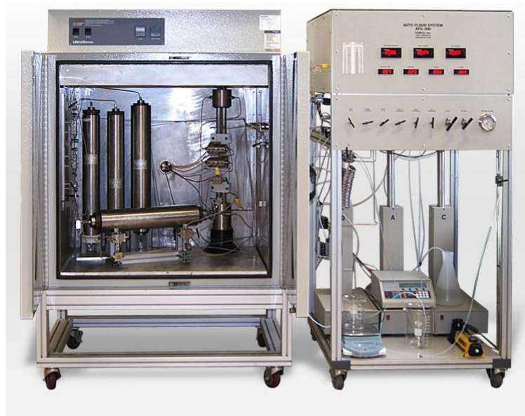
Рис. 2 - Система автоматического заводнения керна в пластовых условиях AFS-300 (США)
