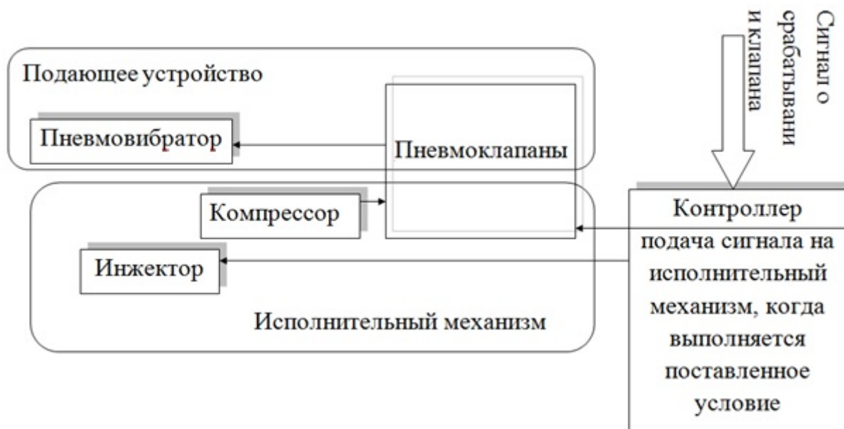
Рис. 2. Структурная схема исполнительного блока экспериментальной установки 3D сканирования.
