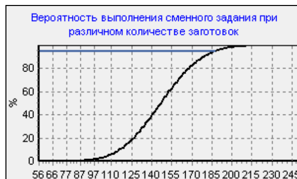
Рис. 3 – Гистограмма (а) и вероятностная кривая (б) распределения числа заготовок в составе сменного задания
