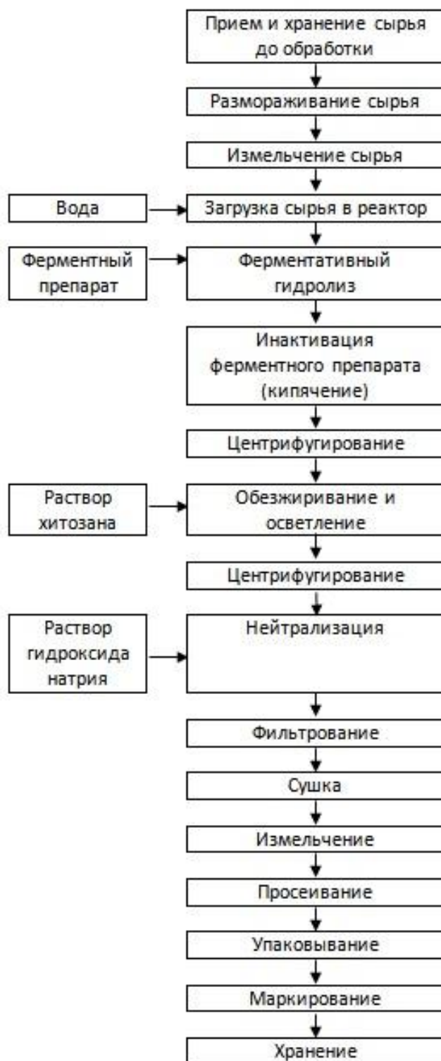
Рис. 3 – Схема переработки рыбных отходов с применением технологии ферментативного гидролиза
