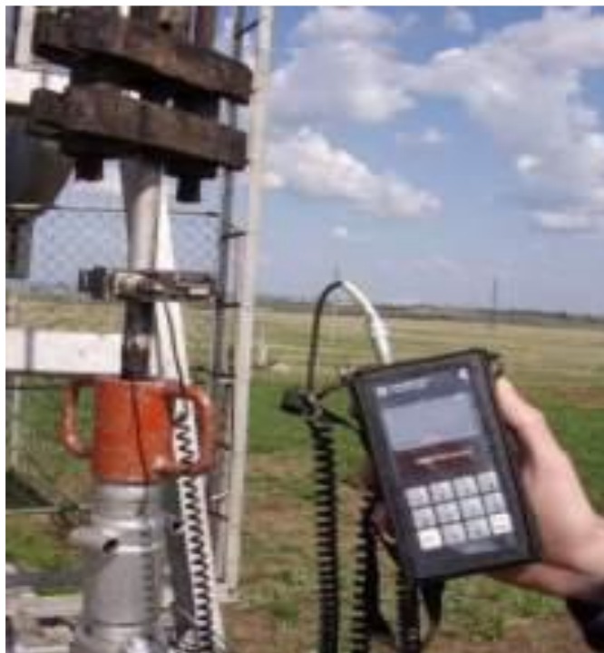
Рис. 26 – Смонтированный динамометр
