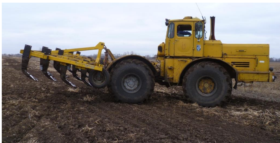
Рис. 2 – Пахотные агрегаты с тракторами: а) тягового класса 3 Claas Axion 830 и орудием ПБФР-3,8; б) тягового класса 5 K-701 и орудием ПБФР-5
