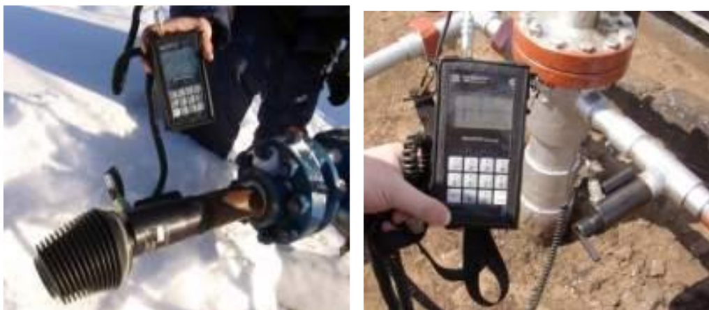
Рис. 2а – Смонтированный эхометр
