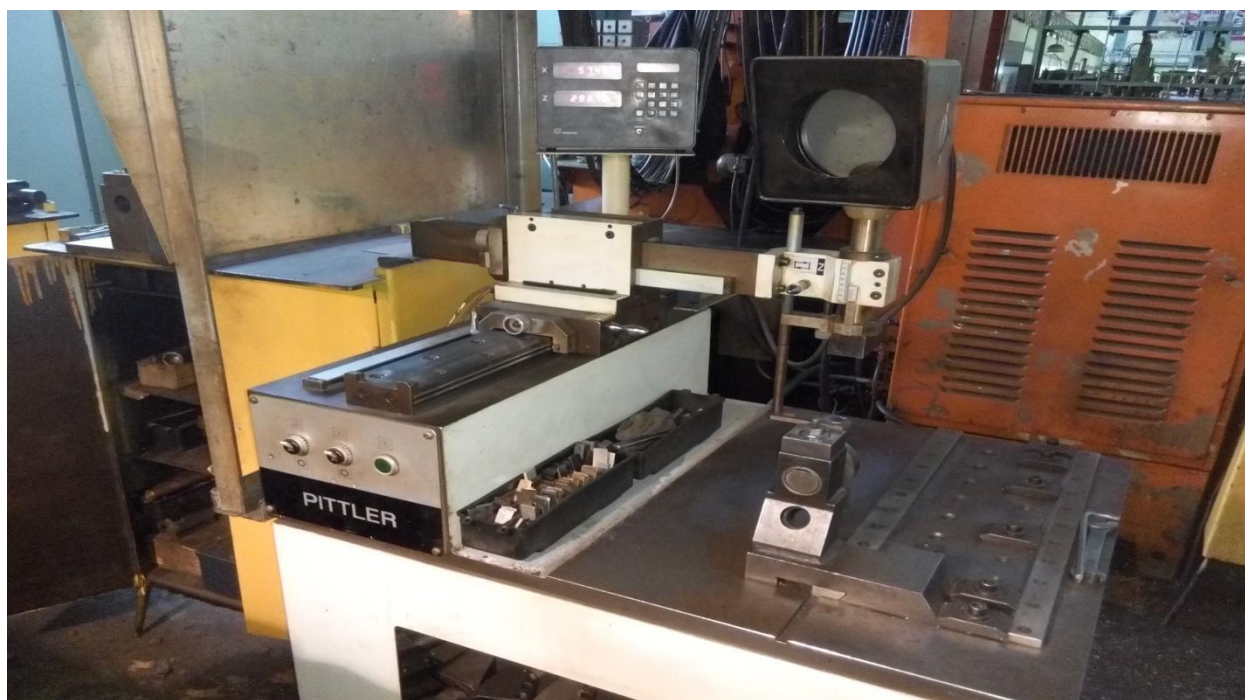
Рис. 1 – Прибор для выставления инструмента по высоте центров
