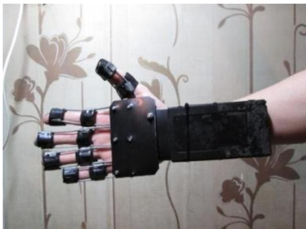
Рис. 1 – Перчатка, усиливающая мышечную силу руки
