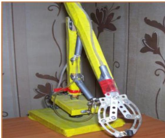
Рис. 2 – Манипулятор, позволяющий поднимать и переносить груз
