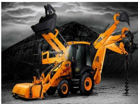
Рисунок 1 - Пример оснащения рабочим оборудованием многофункциональной техники модульного типа DOI: https://doi.org/10.23670/IRJ.2023.132.48.1
