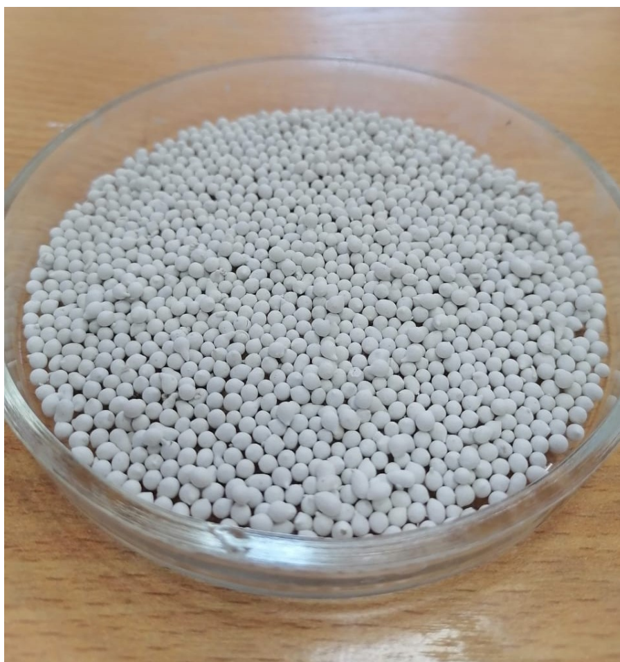
Рисунок 1 - Гранулированный ионообменный материал на основе протонированного полтитаната калия DOI: https://doi.org/10.23670/IRJ.2023.138.98.1
