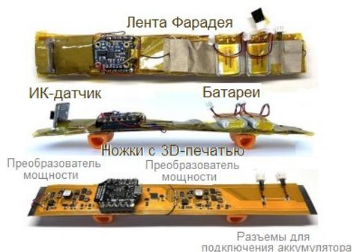
Рисунок 1 - Робот с пятью приводами
