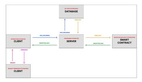
Рисунок 2 - Архитектура взаимодействий отдельных систем DOI: https://doi.org/10.23670/IRJ.2024.142.6.3
